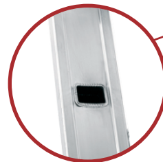
Spoj klina in stojine dosežen s tehnologijo širjenja in orbitalnega kovičenja, kar zagotavlja trdnost in togost lestve.
